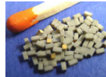
Piezokeramik Au-Pd-metallisiert 0,4 x 0,4 x 1,5 mm
