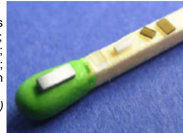
Fenster aus Ge, 1 x 3,2 mm; Saphir 1,5 x 1,5 mm; Ba-Ti, 0,8 x 1,6 mm; SiC 1 x 2 und 2 x 3 mm
