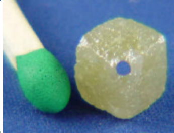
Diamant aus Bild 1 mit Bohrung ø 1 mm.
