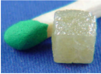
Diamant aus Bild 1 mit Bohrung ø 1 mm.
