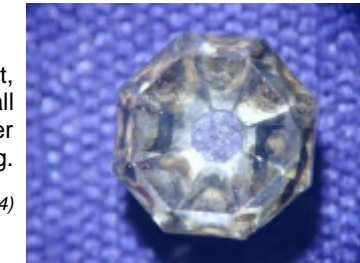
Diamant aus Bild 14 mit Ringnut ø 0,5 x 0,2 mm.
