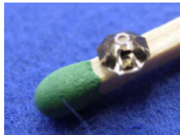
Diamant aus Bild 9 mit Bohrung ø 0,5 x 0,5 mm.
