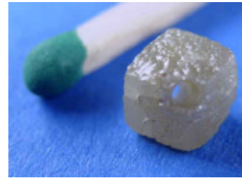
Diamant aus Bild 1 Bohrung ø 1,5 mm.
