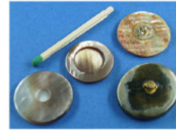
Perlmutterbearbeitung. Rückseite von Knöpfen zur Montage von Befestigungsteilen.
