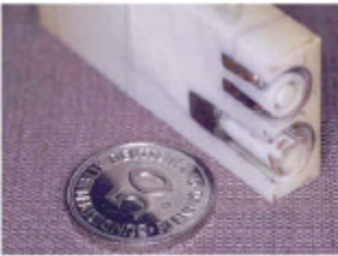
Bearbeitung von Zirkonoxid mit Bohrungen und Radien.
