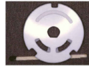
Resonatoren und Abstimmstifte aus Bariumtitanat, Quarz und Saphir.
