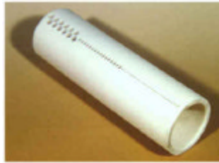
Resonatoren aus Aluminiumoxyd, teilweise metallisiert.
