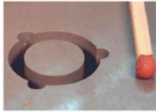
Bohrungen in PSZ. In den Bohrungen sind die Reste von Diamantfräsern aus weniger erfolgreichen Bearbeitungsversuchen.
