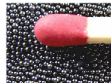
Kugeln aus YIG, ø 0,15 bis 0,6 mm.
