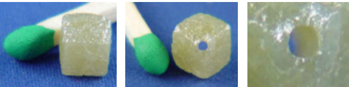
Rohdiamant 5 x 5 x 5 mm vor und nach der Bearbeitung.
