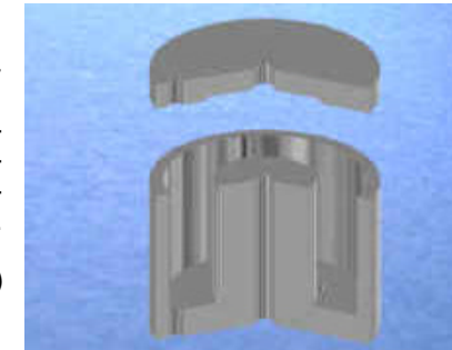
Ferrit C-Kern mit Deckel. Luftspalt durch Absatz im Deckel. Bohrungen für Leitungsführung in Boden und Deckel.
