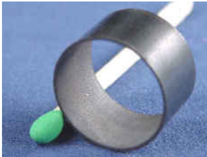
Ferritring \varnothing 18 x 12 mm. Bearbeitet mit Bohrungen \varnothing 12,6 und \varnothing 6,1 mm.
