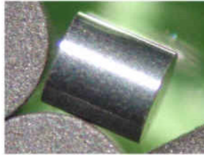
Ferritzylinder \varnothing 0,6 x 0,6 mm, Umfangsfläche poliert.
