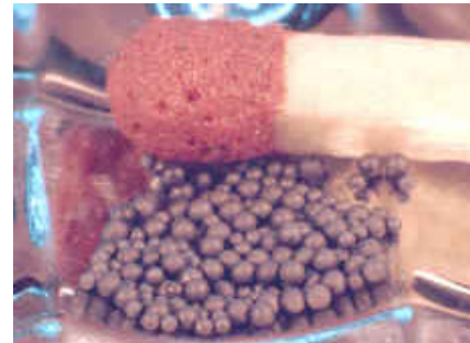
Ferritkugeln \varnothing 0,3 bis 0,7 mm, Oberflächen feingeläppt.
